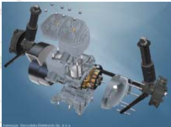
Rys. 16. Zrzuty ekranowe z animacji przygotowanej przez firmę Servodata Elektronik sp. z o.o. Na górnym rysunku widoczny model układu napędowego Mikrusa w częściowym rozłożeniu...
