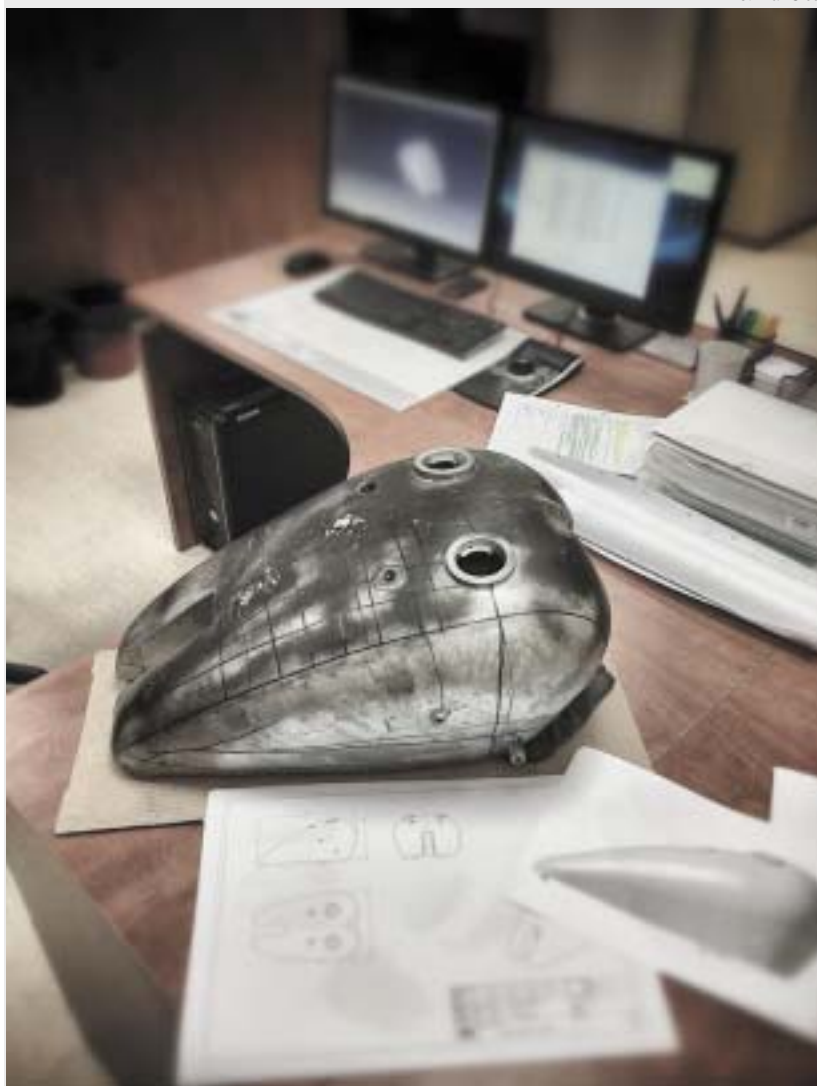
To w WZM powstał, na bazie dokumentacji technicznej oryginalnego baku Sokoła (na zdjęciu), fizyczny model 3D bryły baku. Tak rozpoczęto właściwą produkcję prototypu baku, który wykonano w całości z aluminium...
