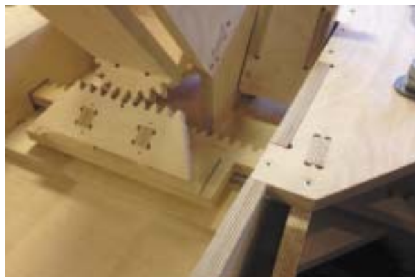
Drewniane detale w całej okazałości. Poniżej: zębatkowa przekładnia kierownicza :)
