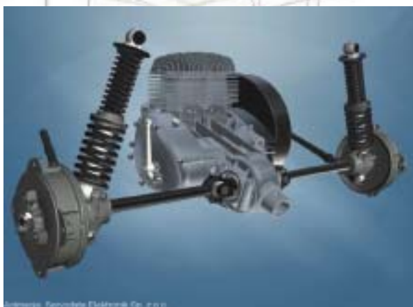
Rys. 16. Zrzuty ekranowe z animacji przygotowanej przez firmę Servodata Elektronik sp. z o.o. Na górnym rysunku widoczny model układu napędowego Mikrusa w częściowym rozłożeniu...
