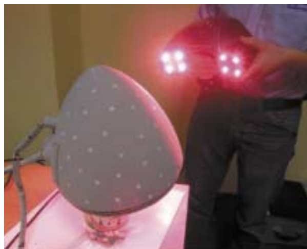
Rys. 1. Przykład pobierania danych w procesie inżynierii odwrotnej – skanowanie klosza reflektora i efekt w postaci chmury punktów (po prawej)
