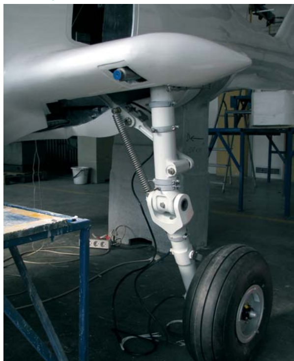
Dzięki takiej konstrukcji podwozia, „Orka” może lądować w przygodnym terenie, a na pewno – na trawiastym pasie lotniska.
