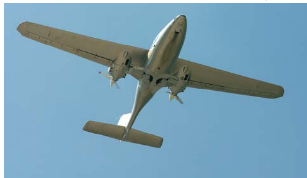
„Orka” w locie. Wyraźnie widoczne chowane podwozie i dolne osłony gondoli silników. Sylwetka samolotu wywołuje skojarzenia z szybowcami...
