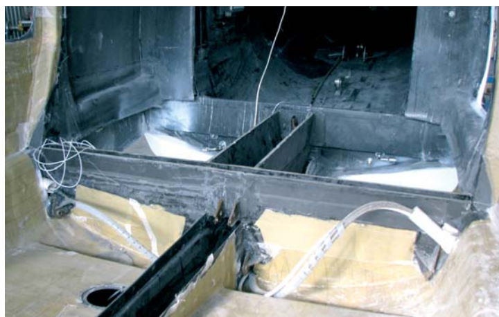
Wnętrze kadłuba, widoczna przestrzeń bagażowa, a także wiązki okablowania wnikaące do wnętrza mechanizmów chowania podwozia.
