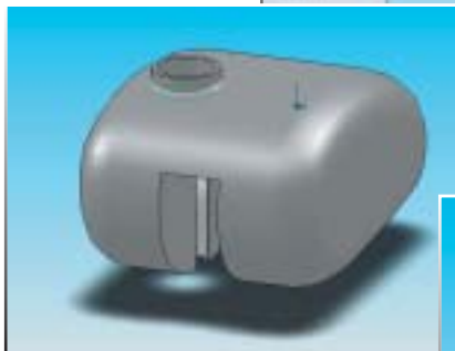
Rys. 17, 17a, 17b. Wykonanie operacji Wyciągnięcia wycięcia z poziomu pozornego otworu wlewowego może zakończyć się... błędami. Nie o taki efekt nam chodziło.
