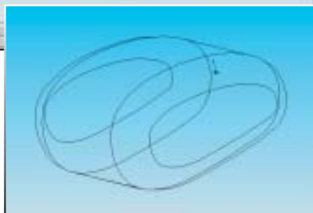
Rys. 6, 6a, 6b. Operacja zaokrąglenia krawędzi zbiornika i uzyskany efekt.
