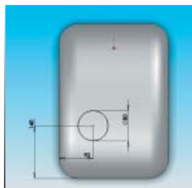
Rys. 7. Szkic okręgu wykorzystany do wyciągnięcia otworu wlewowego. Inteligentne wymiary pomagają zorientować otwór na powierzchni
