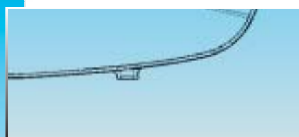
Rys. 21d. To samo z otworem gwintowanym do zamocowania kranika paliwa.
