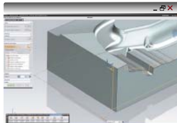
Rys. 4. Przesunięcie przedniej ścianki modelu
