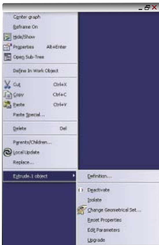
Rys. 5. Izolacja elementów powierzchniowych
