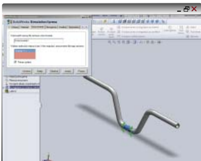
Rys. 4. Określenie miejsca umocowania
