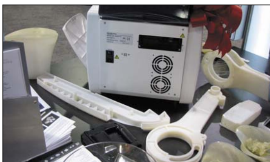
Fot. Urządzenie do „drukowania nożem” firmy Solido zdumiewa wielkością (czyli małością) swoich gabarytów. Przykład technologii LOM w praktyce...
