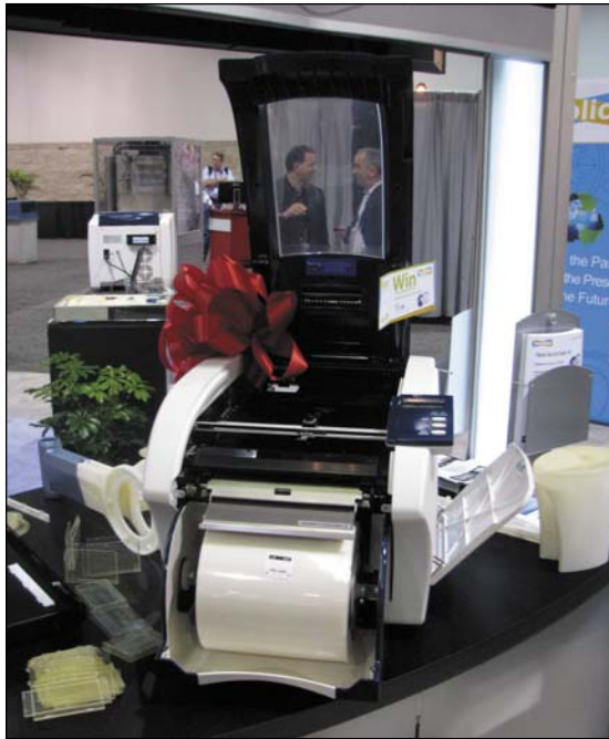
Fot. Urządzenie do „drukowania nożem” firmy Solido zdumiewa wielkością (czyli małością) swoich gabarytów. Przykład technologii LOM w praktyce...
