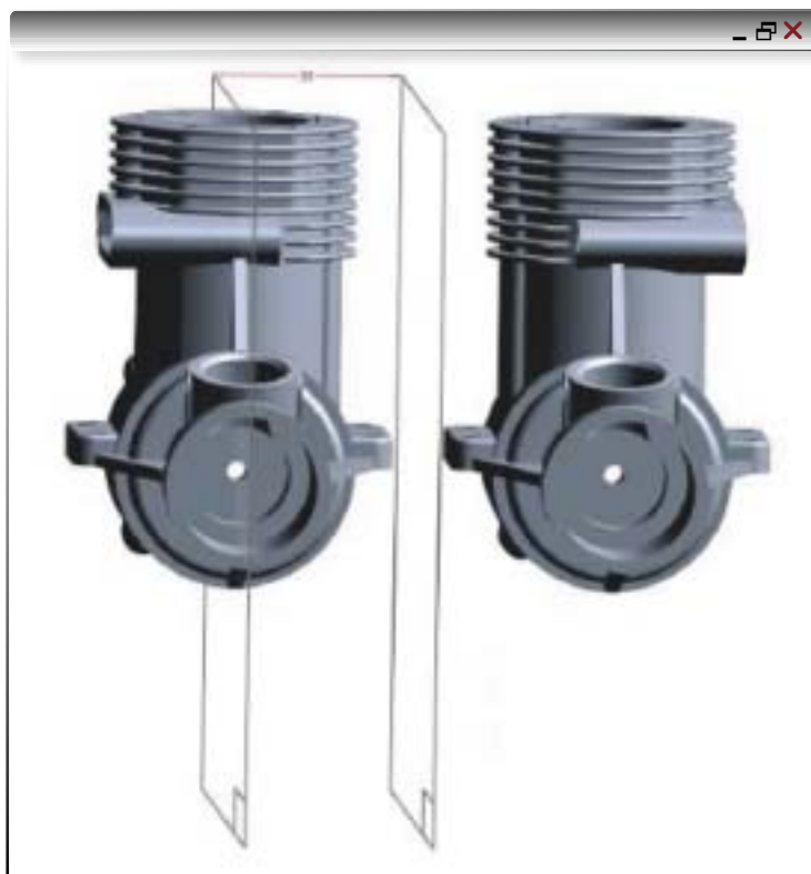
Rys. 2. „Lustrowanie”. Po lewej model wyjściowy, po prawej – „odbitka”
