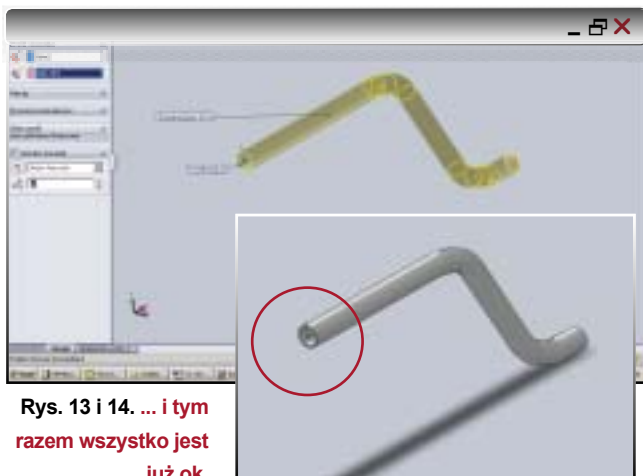
Rys. 12. Oto oczekiwany „piękny widok” naszego fragmentu kierownicy. Tyle, że przypomina on kawał zgiętego metalowego pręta, a nie rurki... Czy znowu o czymś zapomnieliśmy? Tak, podczas operacji wyciągnięcia nie zaznaczyliśmy opcji „Cienkie ściany”. Wykonuję operację od nowa...
