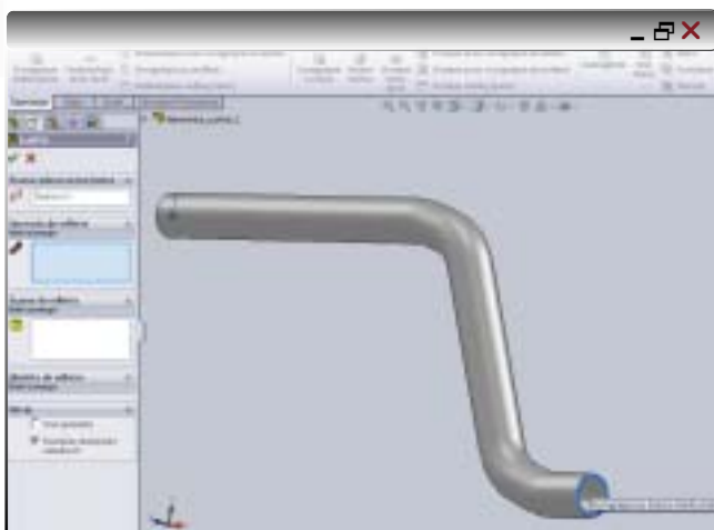
Rys. 15. Operacja „Lustro”. Zaznaczam ściankę, względem której nastąpi „lustracja”...
