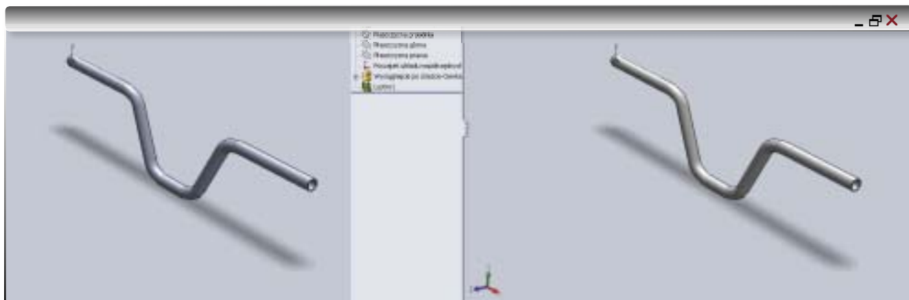
Rys. 22. Po lewej stronie – kierownica z „domyślnego tworzywa”, po prawej – z naszej „chromowanej stali”. Już podczas zwykłej pracy z modelem widoczna jest różnica w zobrazowaniu naszej części).
