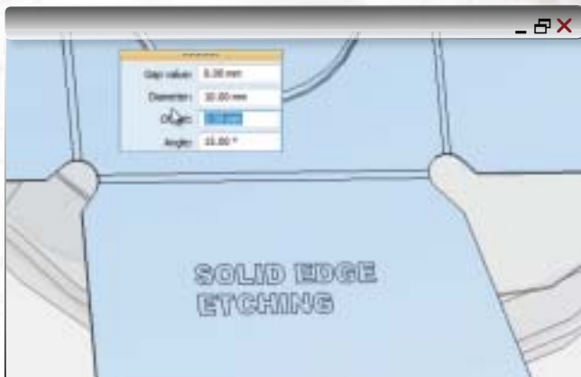
Rys. 9a i 9b. Większa liczba opcji zamkniętych narożników, np. U-kształtnych. Poniżej: polecenie wytrawienia pozwala projektantom wypalać na modelach numery części podczas operacji obróbki laserowej.
