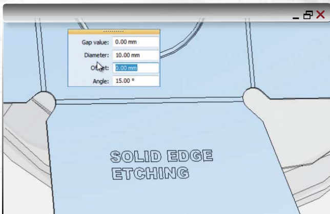
Rys. 9a i 9b. Większa liczba opcji zamkniętych narożników, np. U-kształtnych. Poniżej: polecenie wytrawiania pozwala projektantom wypalać na modelach numery części podczas operacji obróbki laserowej.
