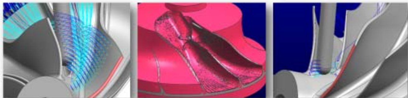
Rys. 12. Obróbka zgrubna, półfabrykat i obróbka resztek.
