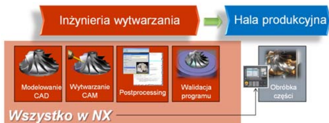
Rys. 4. Przebieg typowego procesu w oparciu o CAx
