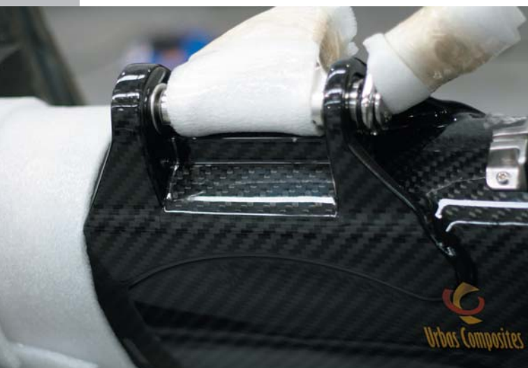
Rys. 11. Gotowy zawias doklejony do masztu
